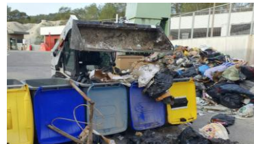
2) Prélèvement d'un échantillon d'environ 500 kg à partir d'un camion dépoté au sol
