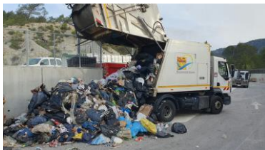
2) Prélèvement d'un échantillon d'environ 500 kg à partir d'un camion dépoté au sol
